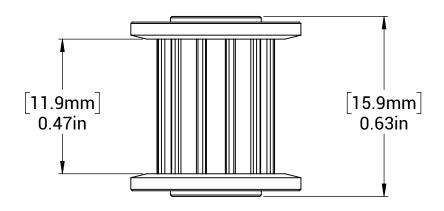
MM SHEET TOLERANCES:  $X \pm 0.50$  MM  $X.X \pm 0.10$  MM  $X.XX \pm 0.05$  MM  $ANGLES \pm 2^{\circ}$
